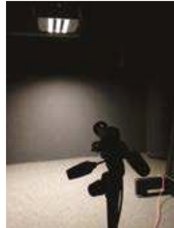
Mesure de luminance effectuée sur un RANA LED Gen 2 Surface 600, UGR<19, atténuée à 4000 lm.
