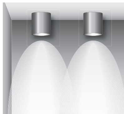
Pose au ras du mur avec version elliptique
